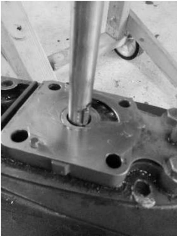
台座がゆがんでいたのでクラッチアーム側のネジ2本もはずして裏からプラスチックハンマーでたたいて平らに矯正した。さらにインペラが回転接触する面をペーパーできれいにみがいてグリスを塗った。
