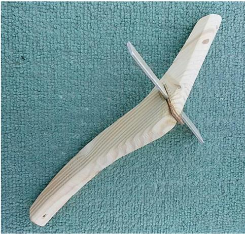
翼を差し込んだ隙間に薄いベニヤ板を差し込み接着すれば翼は固定される。この時、翼の中心を合わせるのと正面からみて左右の傾きがないように固定することが最大の肝である。
