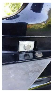
船の水面下の動力部分には必ずアノード(電蝕板)という 亜鉛の金属板が取り付けられています。
