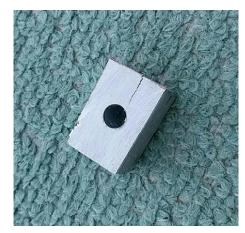
仕上げに表面をグラインダで磨き、中央に6mmの穴を空ければ完成です。純正のものより長く使えるようにやや厚手にカットしました。これで表面を研磨しながら使えば5年間はもつでしょう。
